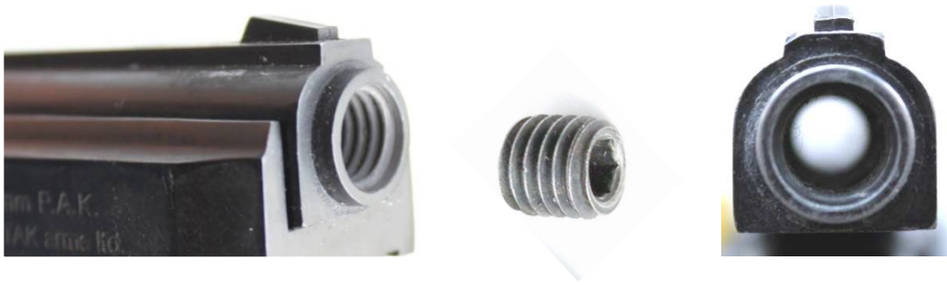
Рисунок 3. Конструктивні особливості ствола пістолета «Zoraki-914» та вилученого з нього запобіжного елемента, призначеного для перешкодження пострілам металевими снарядами
