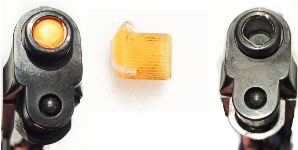
Рисунок 6. Конструктивні особливості каналу ствола пістолета «EKOL Aras Compact» калібру 9 мм Р.А.К.
