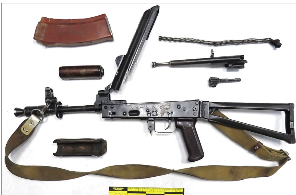
Рис. 3. Складові частини автомата конструкції Калашникова зі складним прикладом укороченого «АКС-74У» калібру 5,45х39 мм
